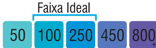
A Dureza Cálcica é a medida de sais de cálcio e magnésio existentes na água. Considera-se como faixa ideal valores entre 100 a 250 ppm. Em valores acima de 250 ppm se inicia o processo de manchas e incrustações que podem causar entupimento de filtros, tubulações e aquecedores. Já em valores abaixo de 100ppm a água se torna corrosiva, pode ocorrer o desgaste de rejuntas.
